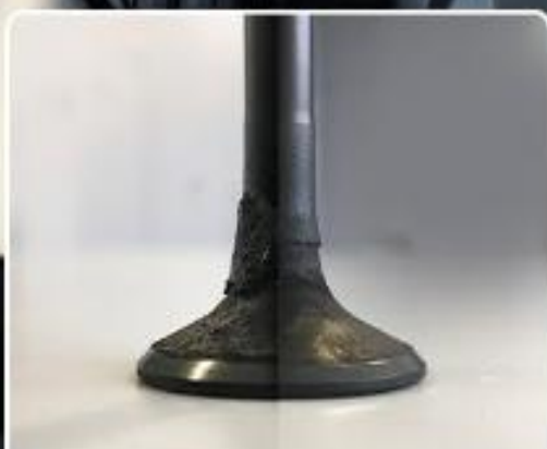
Válvula antes / después
