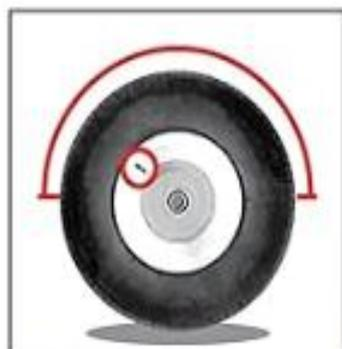
**1** Sitúe la válvula de modo que quede en la mitad superior del neumático
